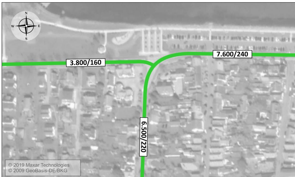
Bild 2-3: Analyse 2019 – DTV,  $DTV_{SV}$
